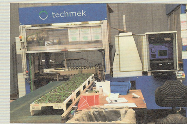
KI-gesteuert arbeitet diese Aussortiermaschine für Stecklinge von Techmek. Foto: Frühwald
